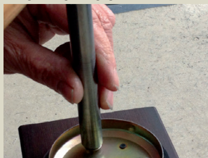
Zusammenbau der Einzelteile durch Anbringen der Federmuttern.
