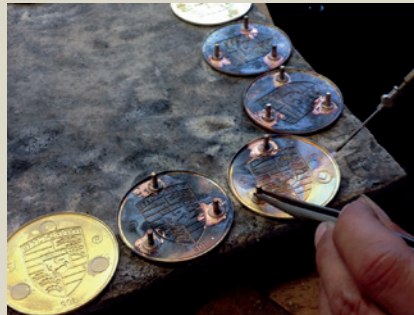
Hartlöten der Stifte nach Ausstanzen der Platine.
